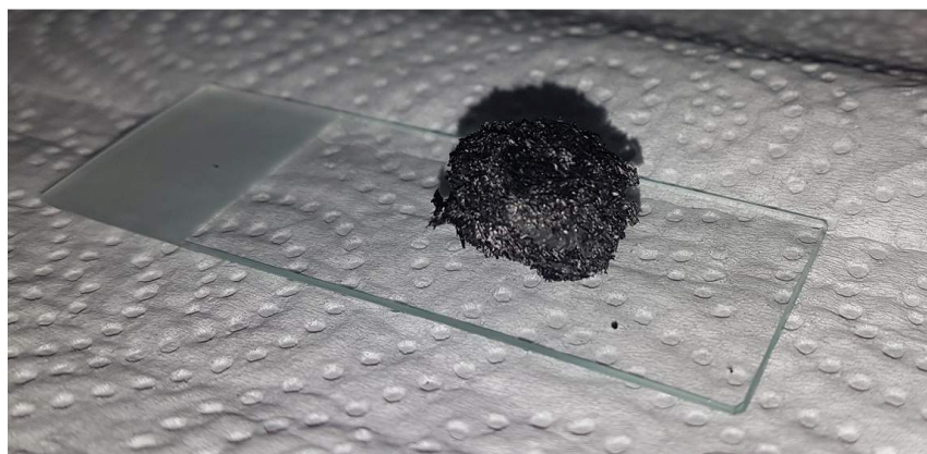
Slika 2.9. Komadić aerogela dobivenog u laboratoriju (osušeni hidrogel)
