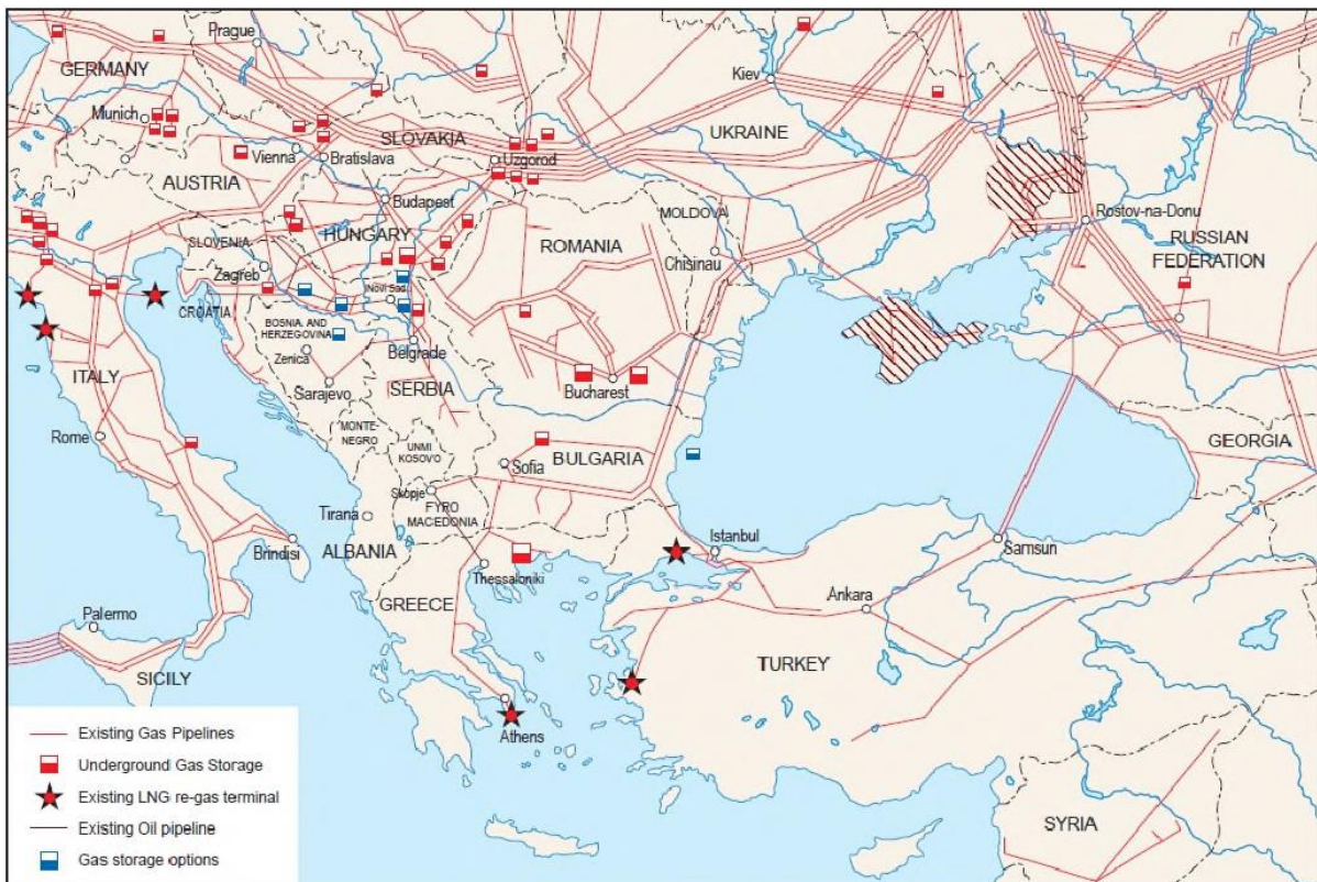
Slika 9.-Prikaz postojećih plinovoda i podzemnih skladišta plina 8
