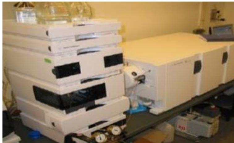
**Slika 12.** Agilent kromatografski sustav Series 1200 sa spektrometrom masa 6410 QqQ
