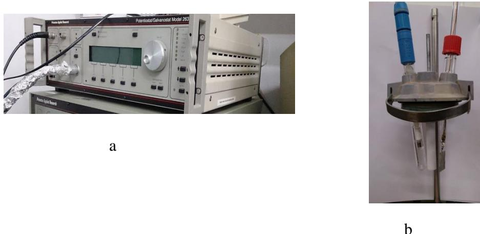
Slika 1. Potencijostat EG&G Princeton Applied Research, model 263A (a) i
