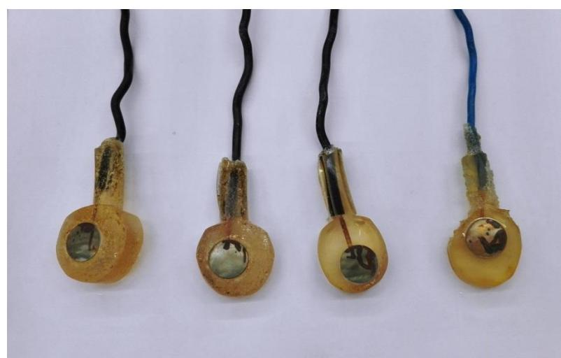
**Slika 4-28:** Izgled legure Cu-Ni nakon 14 dana pri temperaturama od 23°C, 30°C, 50°C i 60°C
