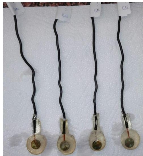
**Slika 3-2:** Uzorci bakar- nikal legure izvedeni kao elektrode
