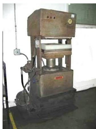
**Slika 20.** Hidraulična preša „Dake“
