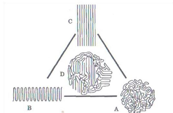
**Slika 10.** Građa polimernih tvari: A-amorfno, B-savijeno, kristalno, C-izduženo, kristalno, D-kristalasto područje
