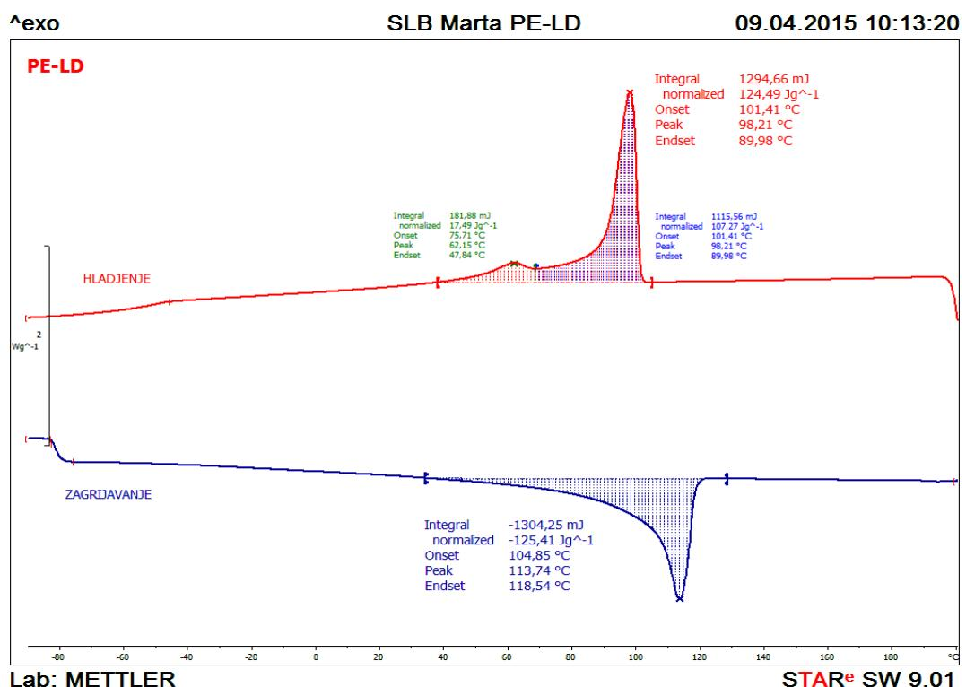
Slika 36. DSC termogram za PE-LD ( polietilen niske gustoće)
