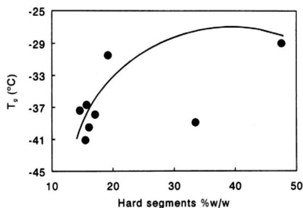
**Slika 40.** Grafički prikaz ovisnosti temperature staklišta o udjelu tvrdih segmenata u PUR-u<sup>12</sup>
