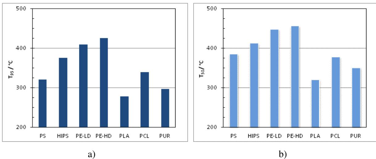
**Slika 46.** Temperatura a) početka razgradnje,  $T_{95}$  i
