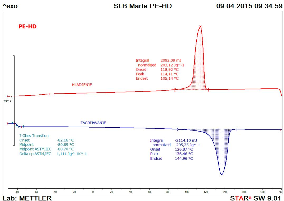
Slika 35. DSC termogram za PE-HD (polietilen visoke gustoće)
