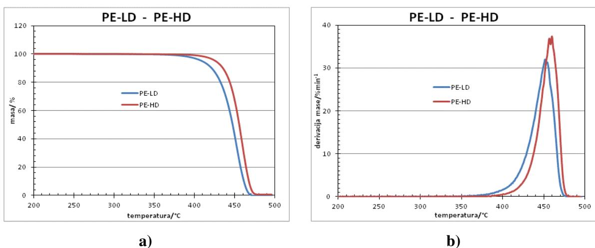
*Slika 43.* a) TG i b) DTG krivulje polietilena niske gustoće (PE-LD) i polietilena visoke gustoće (PE-HD)
