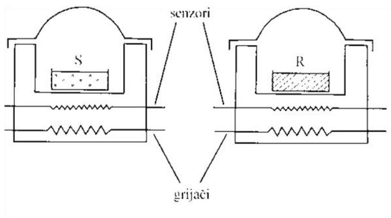
**Slika 13.** Shema DSC uređaja<sup>2</sup>
