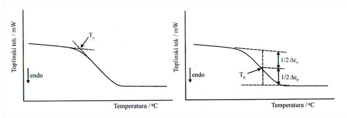
**Slika 15.** Određivanje staklišta iz DSC krivulje<sup>2</sup>
