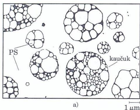
*Slika 25.* Čestice elastomera snimljene elektronskim mikroskopom za HIPS<sup>1</sup>
