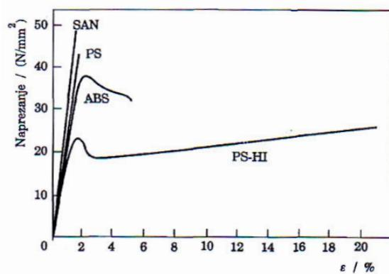
*Slika 26.* Deformacijske krivulje naprezanje ( $\sigma$ )- istezanje ( $\epsilon$ ) za PS, HIPS, SAN i ABS<sup>1</sup>
