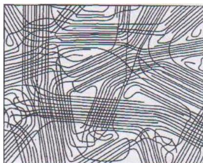
**Slika 28.** Shematski prikaz raspored makromolekula u polietilenu
