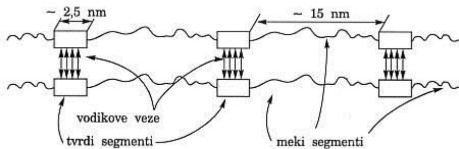
**Slika 31.** Shematski prikaz poliuretanskih blok-kopolimera
