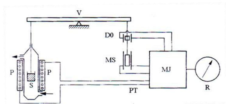
**Slika 18.** Shema TG uređaja: V-vaga, S-uzorak, P-peć, PT-programiranje temperature, DO-detektor nulte točke, MS-magnetski svitak za kompenzaciju mase, MJ-modularna jedinica, R-registracijski uređaj<sup>2</sup>
