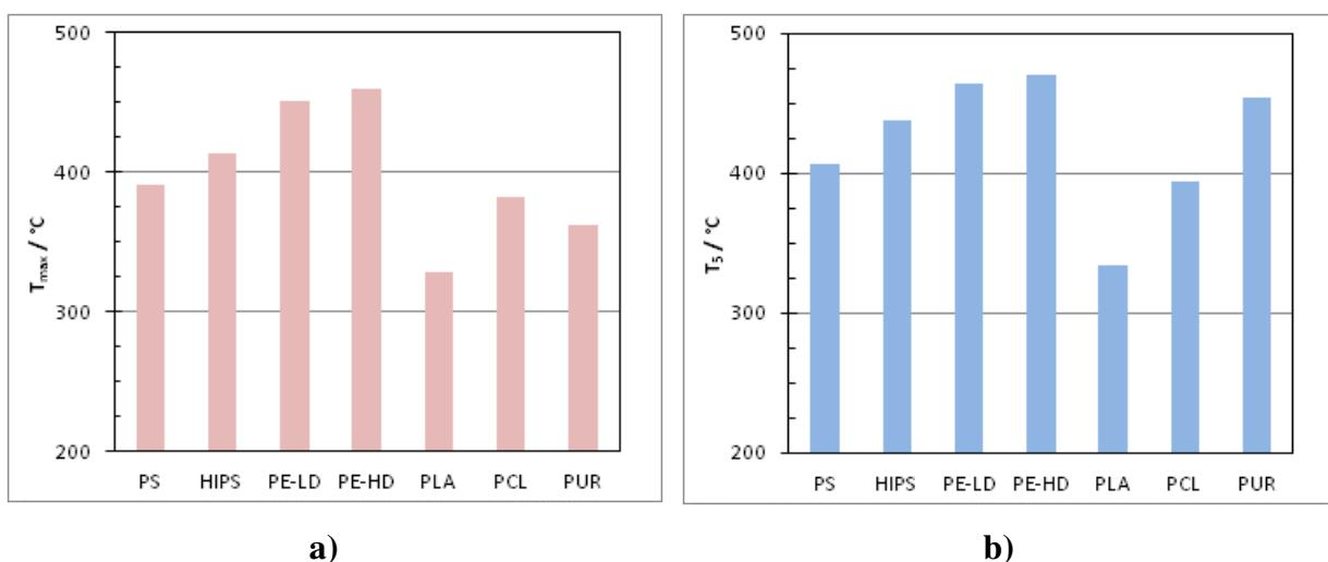
**Slika 47.** Temperatura a) maksimalne brzine razgradnje,  $T_{max}$  i
