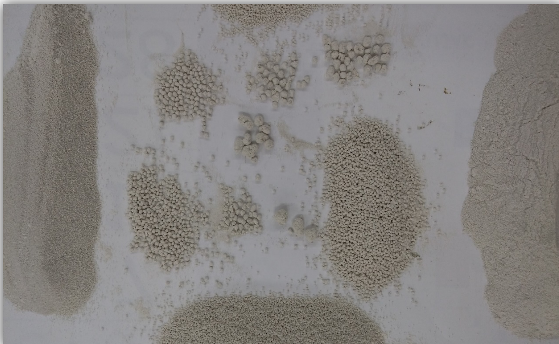
Slika 4.15. Fotografija kolektiva okrupnjenih jedinki dobivenim pri vremenu granuliranja t = 75 \text{ s} .
