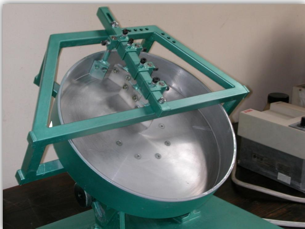
**Slika 3.2.** Fotografija disk granulatora u laboratorijskom mjerilu
