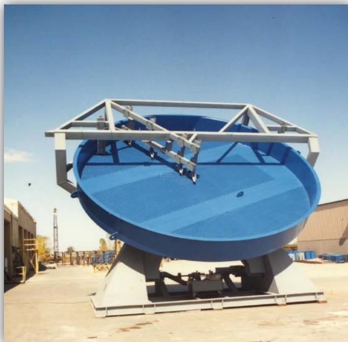
**Slika 2.1.** Fotografija disk granulatora u industrijskom mjerilu.
