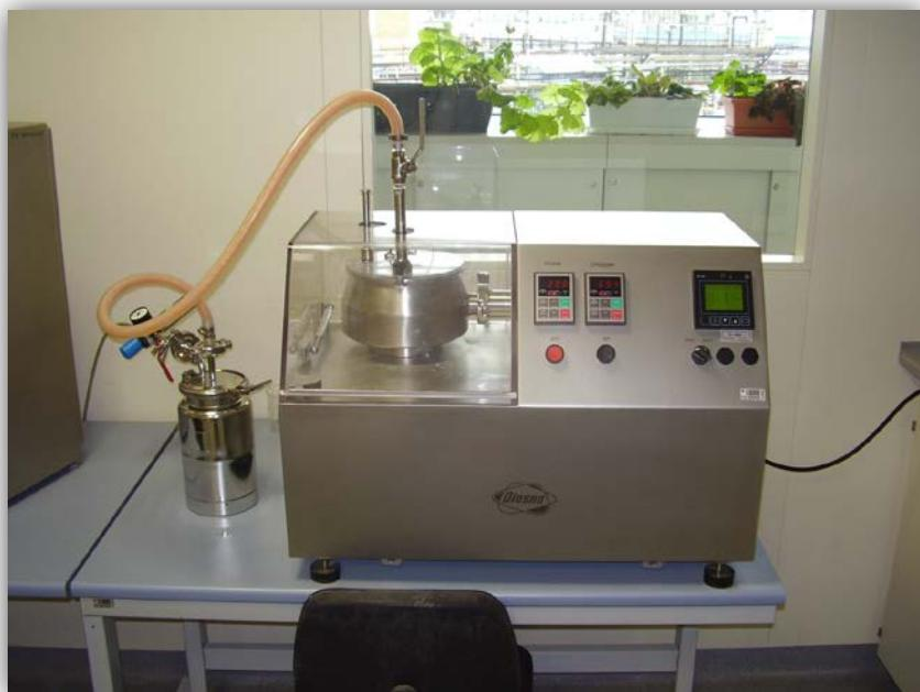
**Slika 2.5.** Fotografija smičnog granulatora
