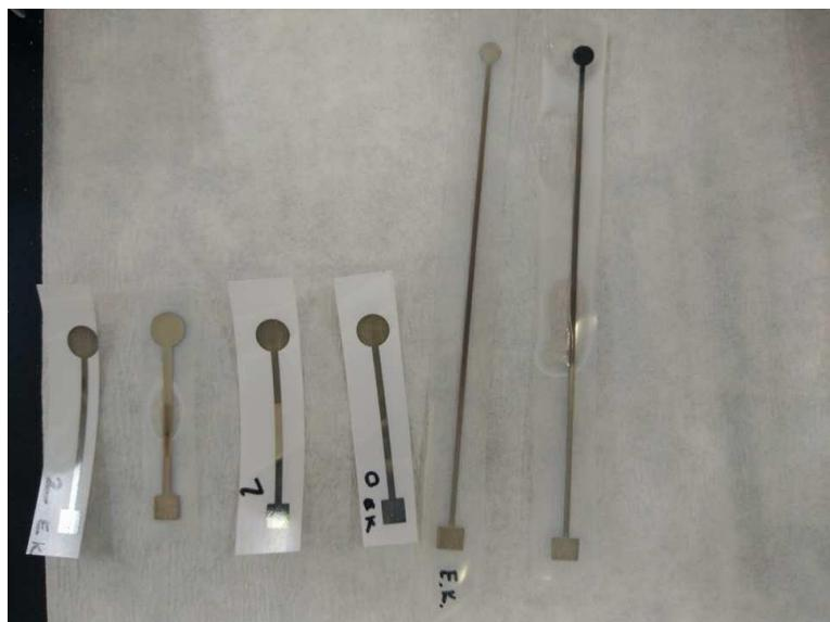
Slika 11. Elektrode modificirane elektrokemijski; sve su pripremljene cikličkom voltametrijom osim zadnje s desna, koja je pripremljena potenciostatski
