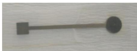
Slika 10. Elektroda modificirana kemijski uz pomoć FeCl<sub>3</sub>
