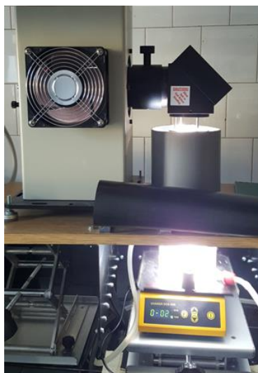
Slika 4. Oriol Newport solar simulator.
