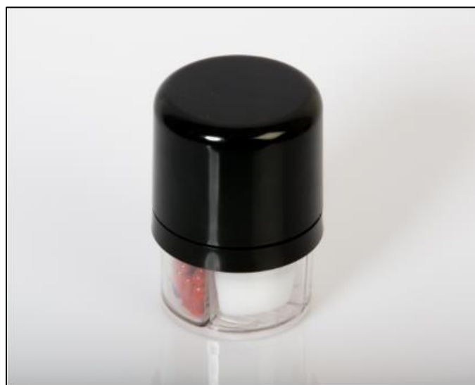
Slika 6. Prikaz pripremljenog sustava za ASAP testiranje; logger cap s unešenim uzorcima i kapsulom za reguliranje vlage u sustavu
