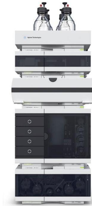
Slika 7. Tekućinski kromatograf visoke djelotvornosti 1290 Infinity II, Agilent Technologies
