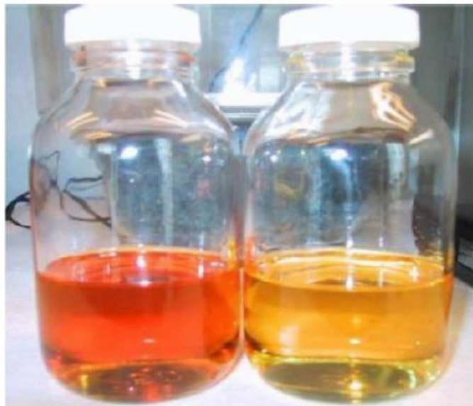
Slika 9. Staro i novo transformatorsko ulje
