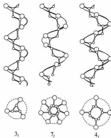
Slika 9. Prikaz spiralnih konformacija izotaktnih vinilnih polimera
