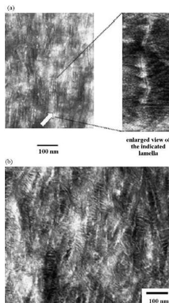
Slika 42. Slike PA6CN3.7 kristaliziranog pri (a) 170 i 210 °C dobivene transmisijskom elektronskom mikroskopijom (TEM) (b) Pokazuje tipičnu vrstu "šiš-kebab" strukture
