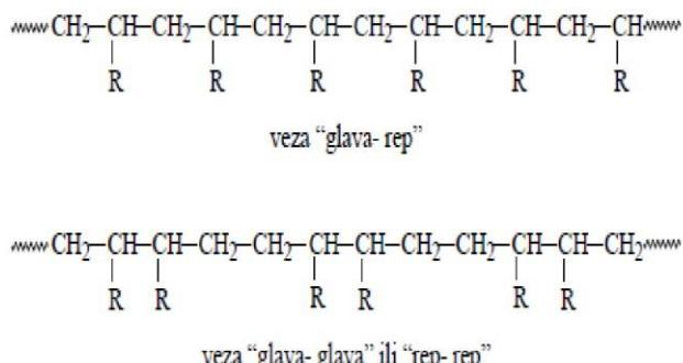
Slika 3. Modeli vezanja ponavljanih jedinica tijekom polimerizacije
