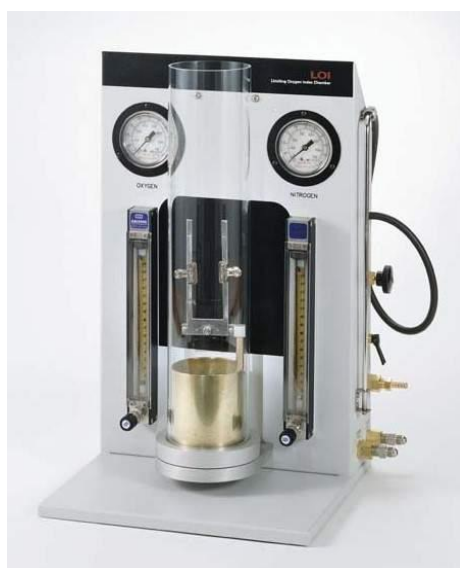
Slika 5. Aparatura za LOI ispitivanja
