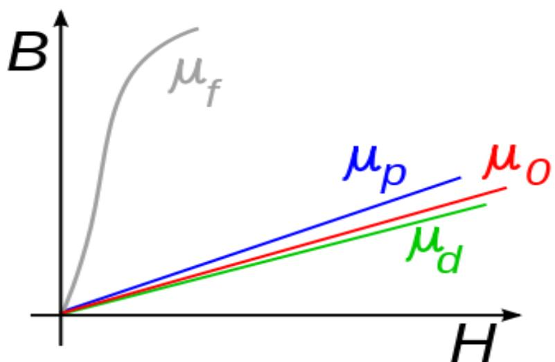
**Slika 1-** usporedba magnetske permeabilnosti paramagnetičkih, dijamagnetičkih i feromagnetičkih materijala
