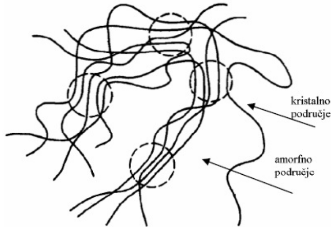
Slika 20. Model kristalastog polimerima prema teoriji resastih micela
