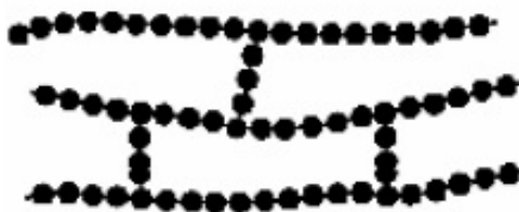
Slika 5. Shematski prikaz umrežene makromolekule 2
