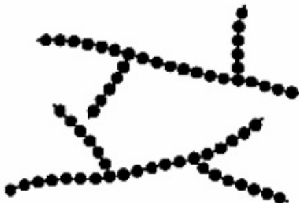
Slika 3. Shematski prikaz granatih makromolekula 2
