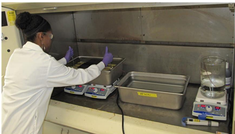
Slika 9. Čišćenje nehrđajućeg čelika u kupeljima otopinom limunske kiseline u kupeljima [19]
