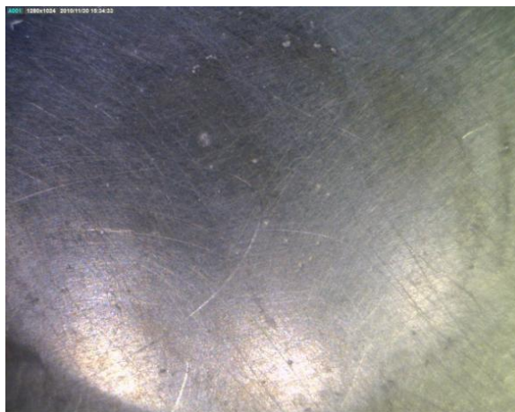
Slika 15. Površina nehrđajućeg čelika nakon (desno) čišćenja u otopini limunske kiseline [7]
