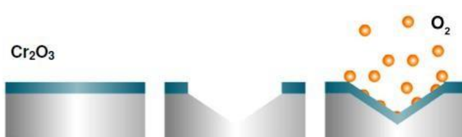
Slika 2. Prikaz samoobnavljanja pasivnog filma kromovih oksida na površini nehrđajućeg čelika [5]
