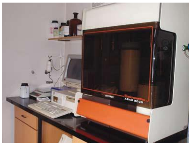
Slika 24. Uređaj za određivanje raspodjele veličina pora, ASAP 2000 Micromeritics
