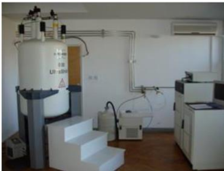
Slika 25. ^1\text{H} NMR Spektrometar Bruker Avance 300
