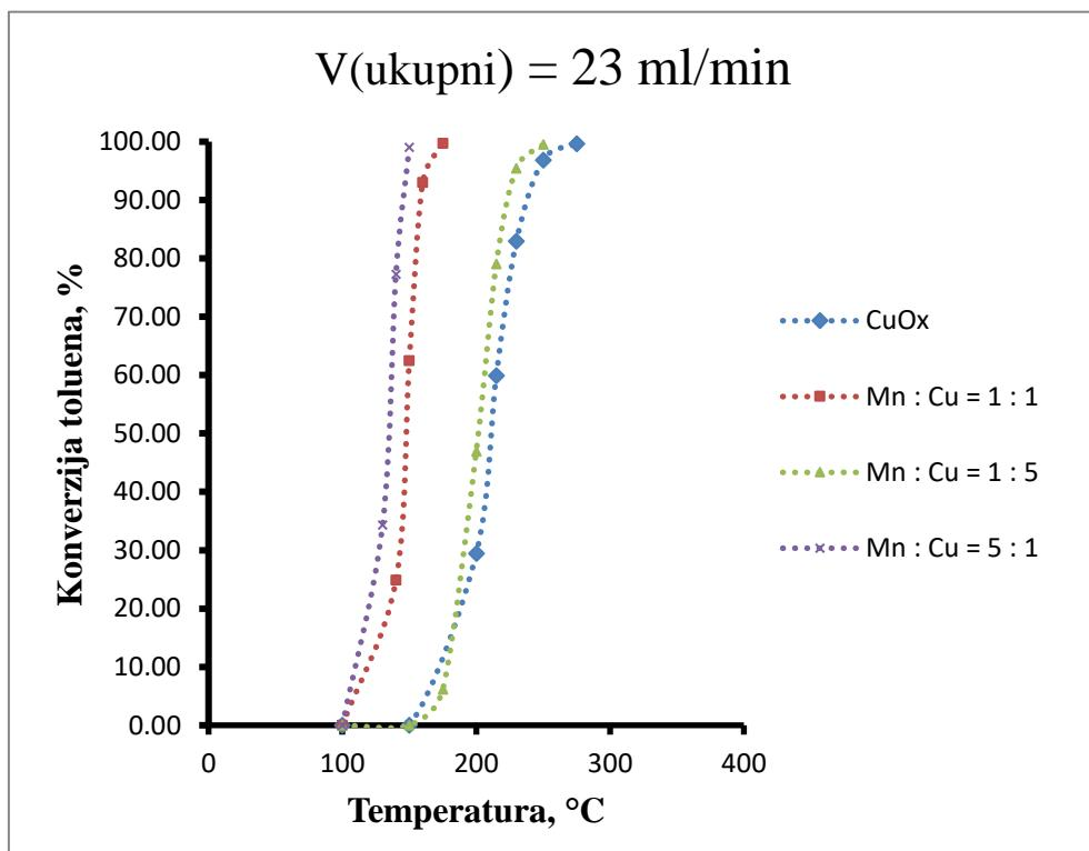
*Slika 5.5. Usporedba metalnih monolitnih katalizatora korištenih u ovom radu pri različitim temperaturama uz konstantnu početnu koncentraciju toluena (210,43 ppm) te pri ukupnom volumenu reakcijske smjese od  $23 \text{ ml/min}$ . (Korišteni su podaci iz tablica 4.1. -4.4.)*
