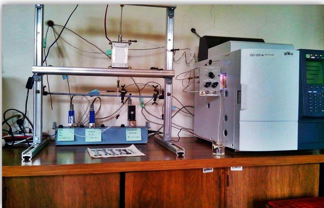
*Slika 3.5. Fotografija eksperimentalnog sustava za provođenje katalitičkih eksperimenta*
