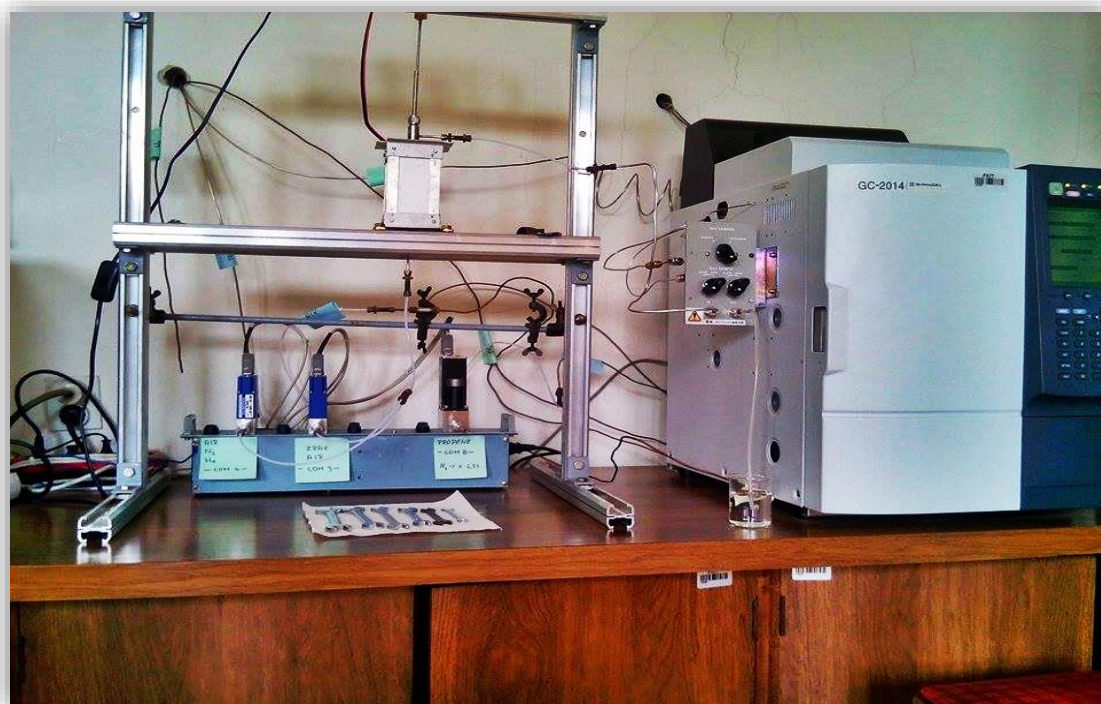
Slika 3.5. Fotografija eksperimentalnog sustava za provođenje katalitičkih eksperimenata
