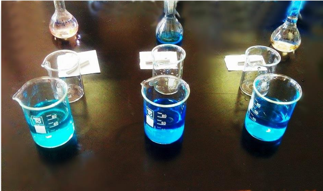
Slika 3.3. Metalni nosači i otopine pripremljene za nanošenje katalitičkog sloja
