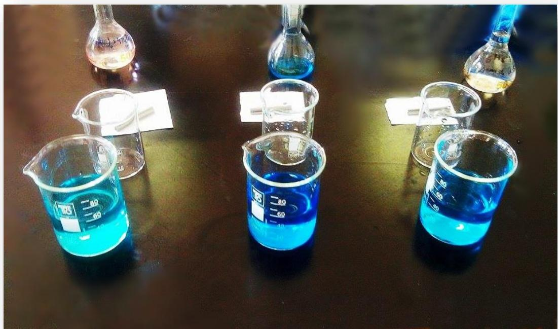
*Slika 3.3. Metalni nosači i otopine pripremljene za nanošenje katalitičkog sloja*
