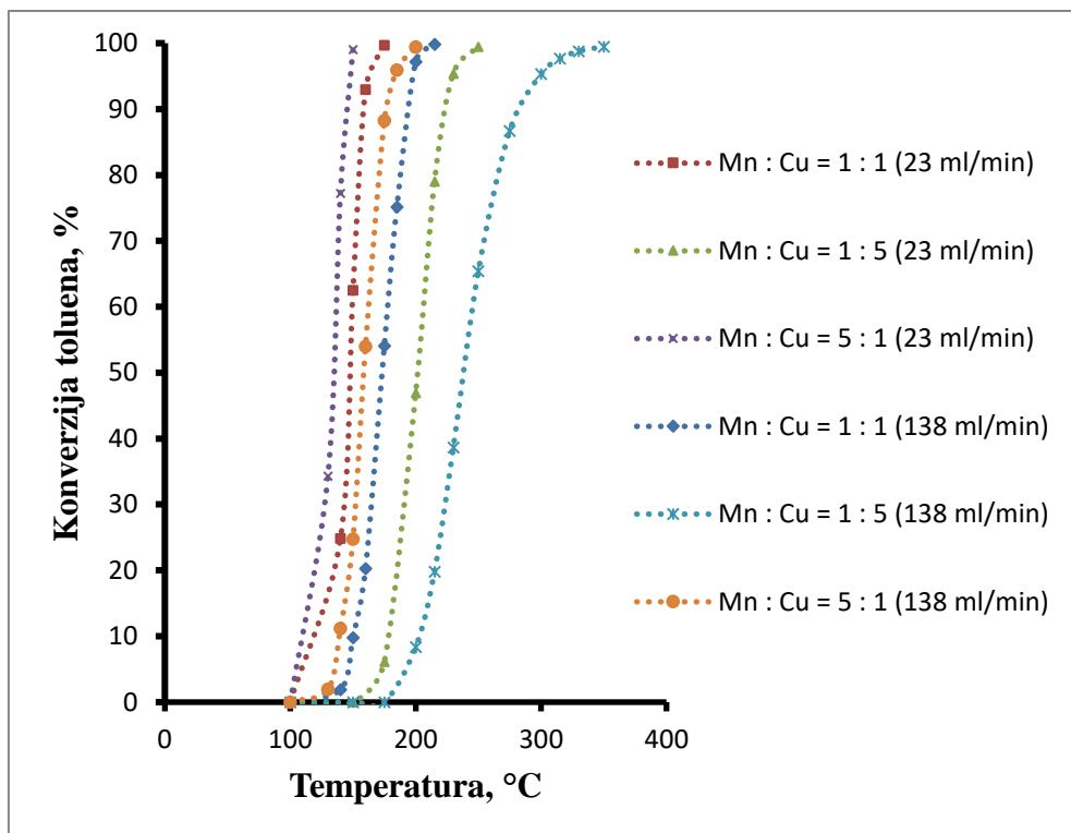
*Slika 5.6. Usporedba monolitnih katalizatora s miješanim oksidom Mn i Cu (Mn:Cu=5:1, Mn:Cu=1:5, Mn:Cu=1:1) pri najvećem od  $138 \text{ ml min}^{-1}$  (◆, ✖, ●) i najmanjem protoku reakcijske smjese od  $23\text{ml min}^{-1}$  (■, ▲, ✎). (Podaci iz tablica 4.2., 4.3., 4.4.)*
