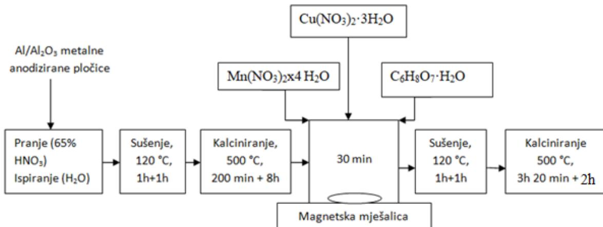
Slika 3.2. Shematski prikaz pripreme metalnog monolitnog katalizatora
