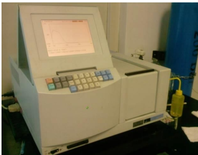
Slika 3.4. UV/Vis spektrofotometar Perkin Elmer Lambda EZ 201
