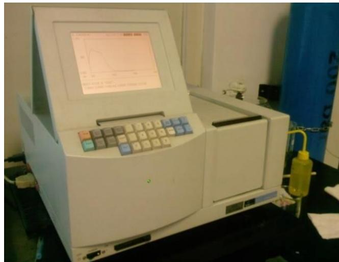
**Slika 3.4.** UV/Vis spektrofotometar *Perkin Elmer Lambda EZ 201*
