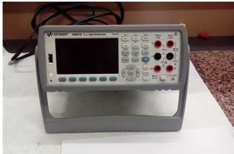
**Slika 3.2.** Uređaj za mjerjenje električnog otpora *Keysight 34461 6 1/2 Digit Multimeter*
