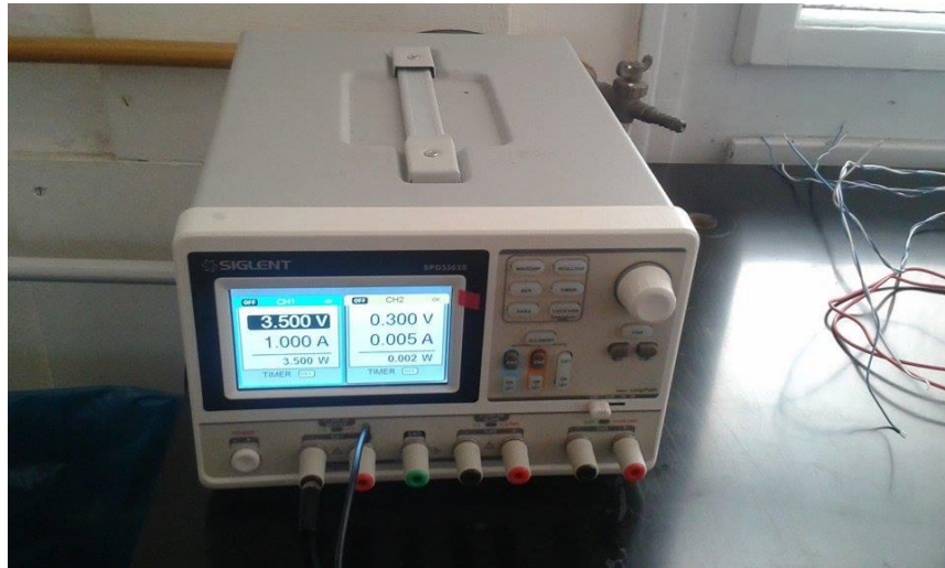
Slika 11. SPD3303s korišten u ispitivanjima
