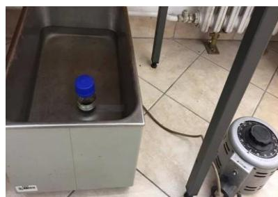
Slika 18. Ultrazvučna kupelj
