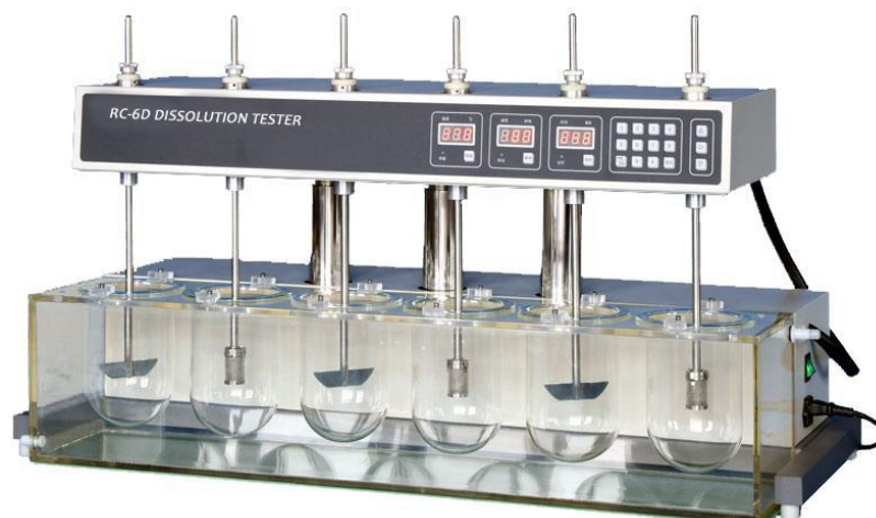
Slika 8. Uređaj za ispitivanje otpuštanja djelatnih tvari (RC-6D, Zhengzhou Nanbei Instrument)
