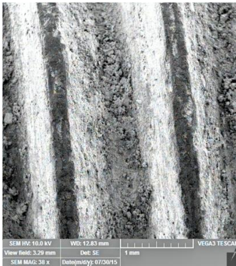
Slika 4.6. SEM slika praha između navoja vijka pri povećanju od a) 40× i b) 2000×.
