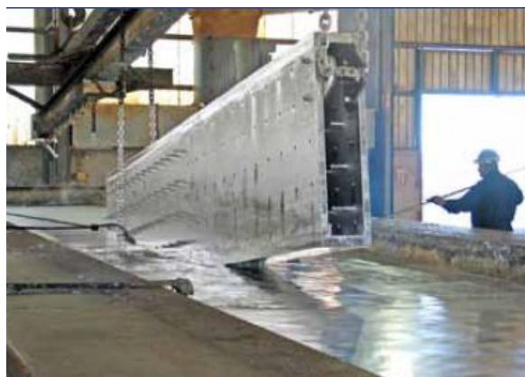
Slika 2.3. Povlačenje predmeta iz kade sa rastaljenim cinkom 3 .
