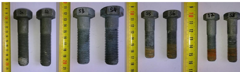
Slika 3.2. Skladišteni, neupotrebljavani vijci (S)
