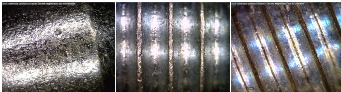
Slika 4.4. Elektrolitički pocinčani vijci pod mikroskopskim povećanjem 60×.
