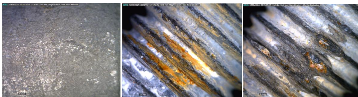
Slika 4.3. Korišteni vijci pod mikroskopskim povećanjem 60×.
