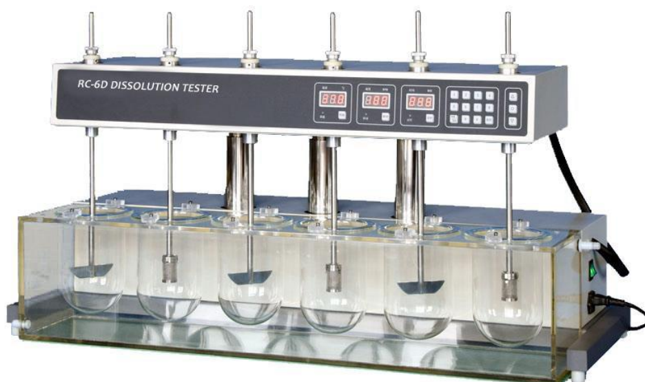
Slika 7. Uređaj za ispitivanje otpuštanja djelatnih tvari (RC-6D, Zhengzhou Nanbei Instrument)
