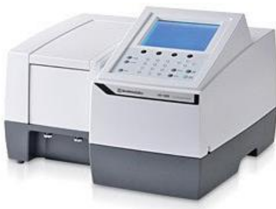
Slika 9. UV/Vis spektrofotometar (UV-1280, Shimadzu)
