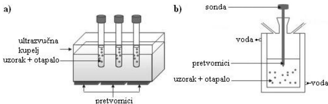
**Slika 4.** Ultrazvučna ekstrakcija: a) neizravna b) izravna metoda [37]
