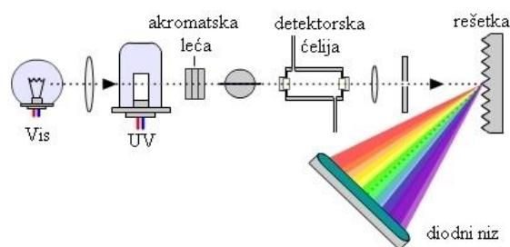
**Slika 6.** Shematski prikaz rada detektora s nizom dioda [43]
