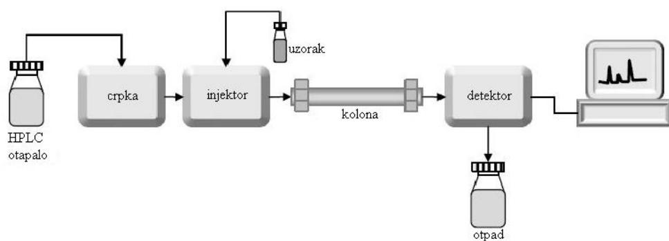
**Slika 5.** Shematski prikaz tekućinskog kromatografa visoke djelotvornosti [42]
