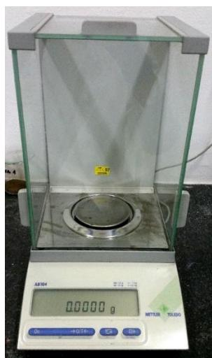
**Slika 7.** Analitička vaga Mettler Toledo, AB104, Švicarska
