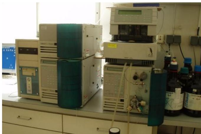
**Slika 14.** Tekućinski kromatograf visoke djelotvornosti, Varian ProStar 500, SAD
