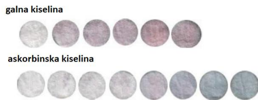
Slika 24. Rezultat kolorimetrijskog senzora baziranog na papiru. 62
