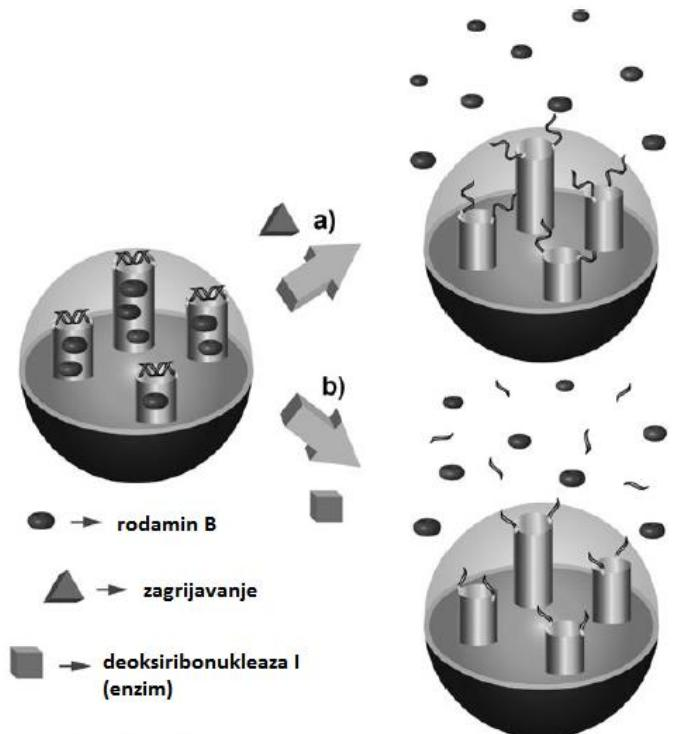
Slika 16. Otpuštanje zarobljenih molekula DNA iz nanočestice pripravljene sol-gel metodom
