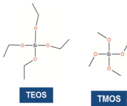
Slika 4. Strukturne formule TEOS-a  $[\text{Si}(\text{OC}_2\text{H}_5)_4]$  i TMOS-a,  $[\text{Si}(\text{OCH}_3)_4]$  [10].
