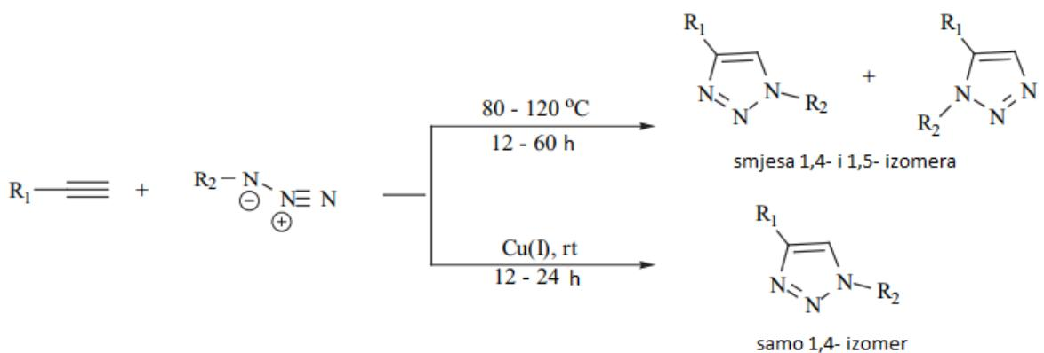
Slika 8. 1,3-dipolarna cikloadicija alkina i azida uz povišenu temperaturu i Cu(I)-katalizirana reakcija
