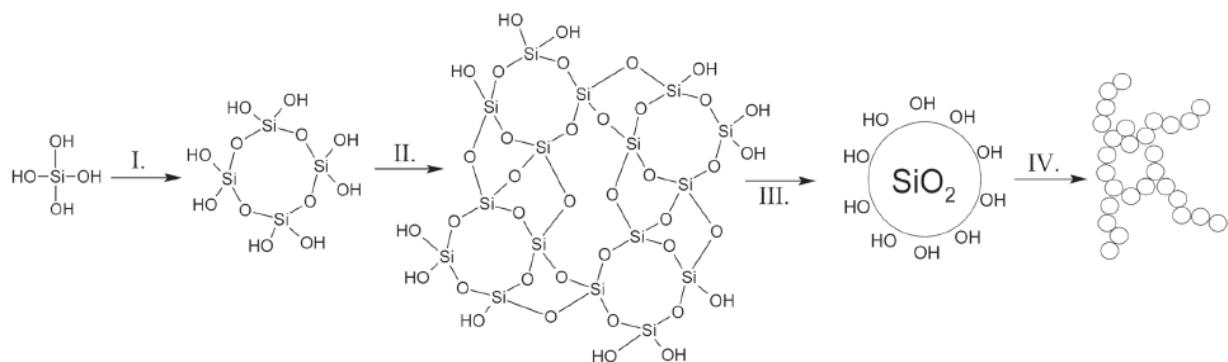
Slika 5. Shema kondenzacije hidroliziranih silicijevih alkoksida: I. nastajanje cikličke strukture, II. nastajanje trodimenzijske  $\text{SiO}_2$  čestice, III. rast čestica IV. povezivanje u trodimenzijsku neprekinutu mrežu, gel.
