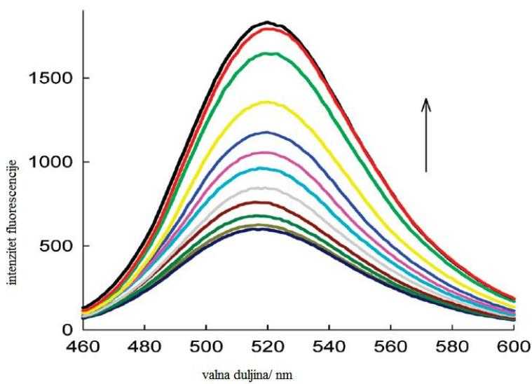
Slika 18. Spektrar emisijske fluorescencije površinskog senzora SBA-15 u puferu (pH=7,2) u vodenoj otopini različitih koncentracija  $Hg^{2+}$ , krenuvši od najmanjih do najvećih u smjeru strjelice.
