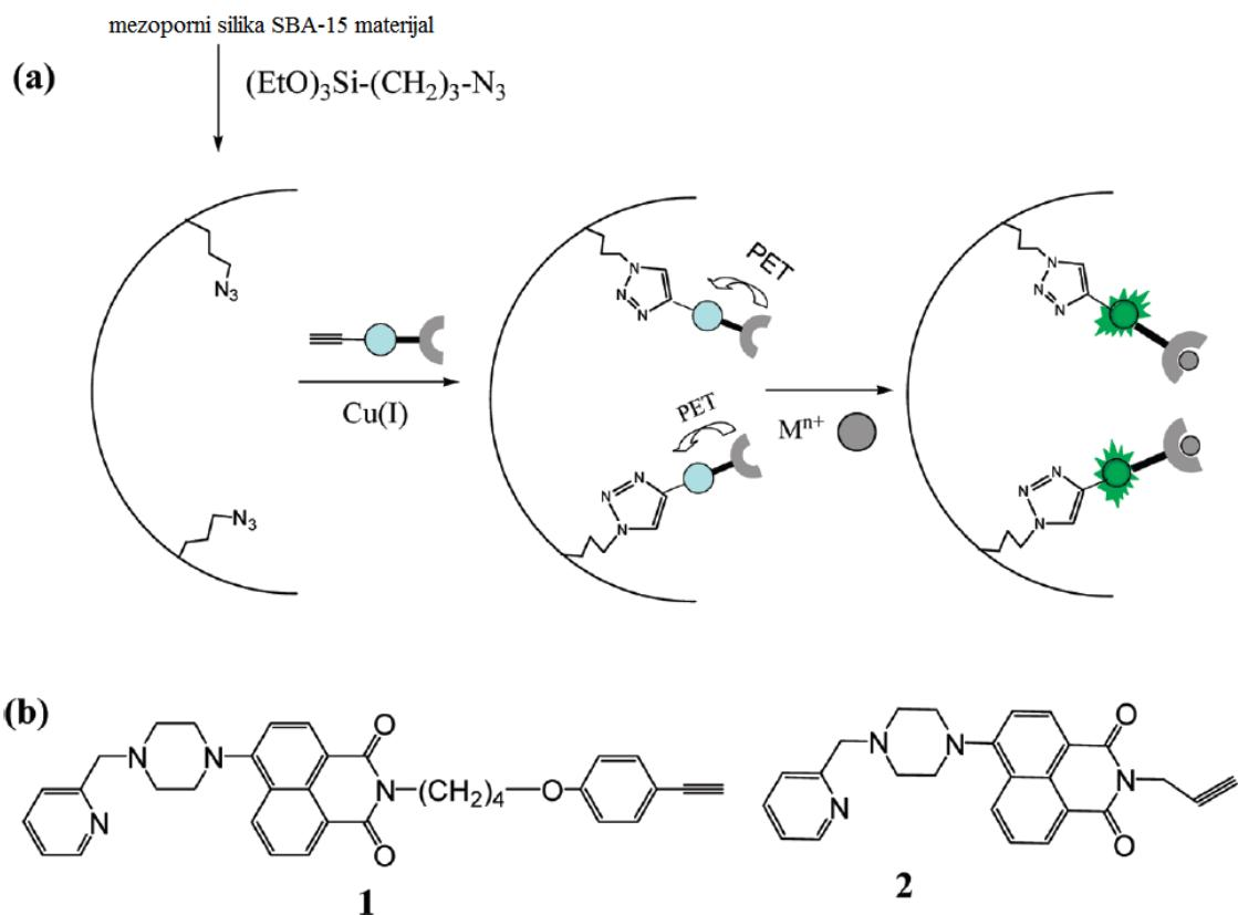
Slika 17. Kovalentno vezanje fluorooionofora na SBA-15 u dvostupnjevitoj CuAAC reakciji
