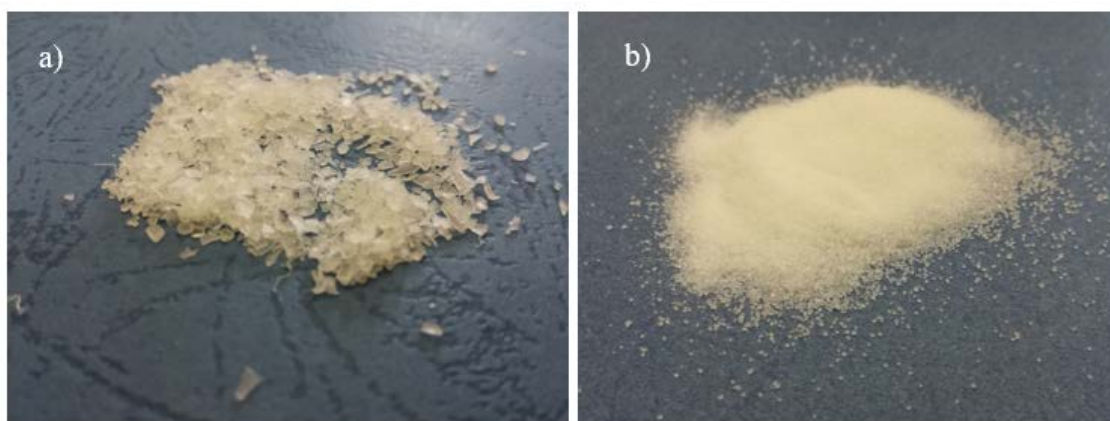
Slika 11. Prikaz korištenog PVA - a) inicijalni, b) usitnjeni
