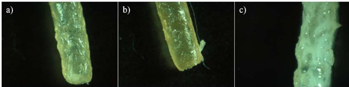
Slika 16. Mikrografija filamenata, uvećanje 32x a) F2500 b) F710 c) filament otopljen u vodi
