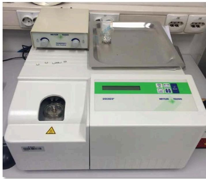
**Slika 17.** Razlikovni pretražni kalorimetar, Mettler Toledo DSC 823e.
