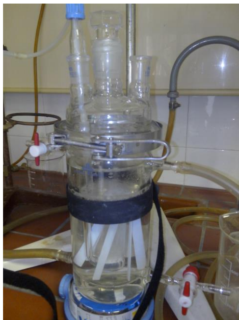
Slika 13. Reaktor za ozonaciju sa uronjenim pločicama
