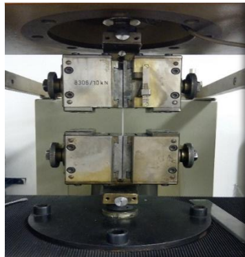
Slika 36. Epruveta polistirena između čeljusti Zwick kidalice 1445
