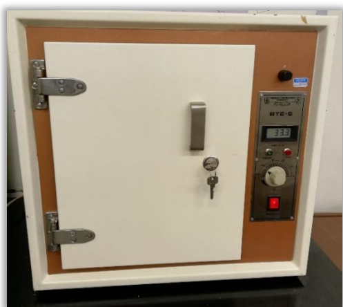
Slika 20. Inkubator i bočice s pločicama PS i PCL polimera stavljene u inkubator, na 37°C u vremenu od 4 tjedna
