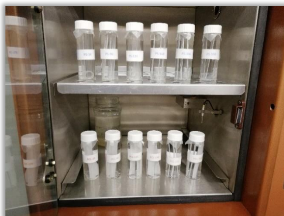
Slika 20. Inkubator i bočice s pločicama PS i PCL polimera stavljene u inkubator, na 37°C u vremenu od 4 tjedna
