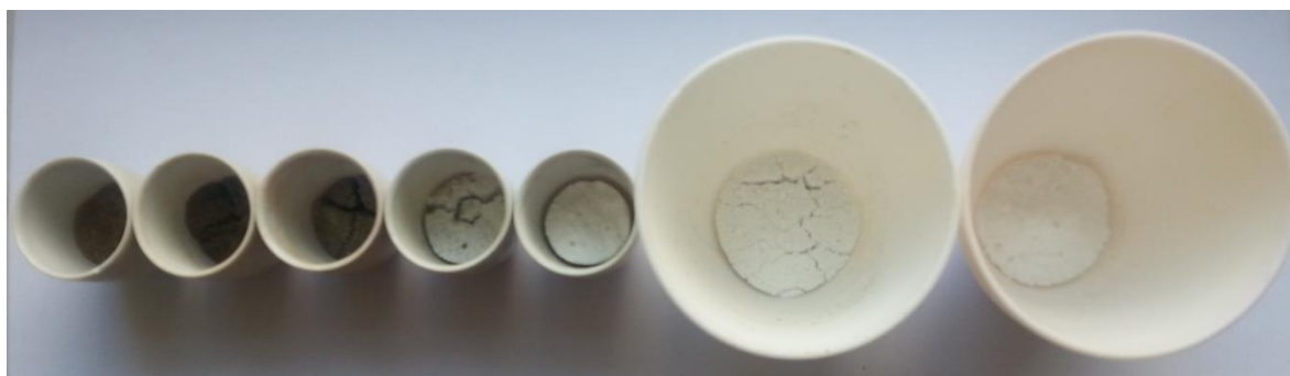
Slika 10. Uzorak CSN1A1 zagrijavan do različitih temperatura (s lijeva na desno uzorci zagrijavani do: 600 °C, 700 °C, 800 °C, 900 °C, 1000 °C, 1100 °C, 1200 °C)
