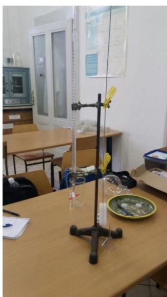
Slika 14. Aparatura za titraciju
