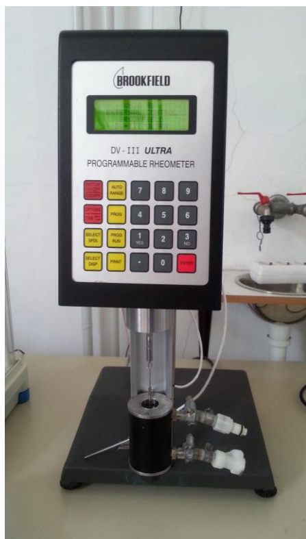
Slika 15. Rotacijski viskozimetar Brookfield DV – III ULTRA
