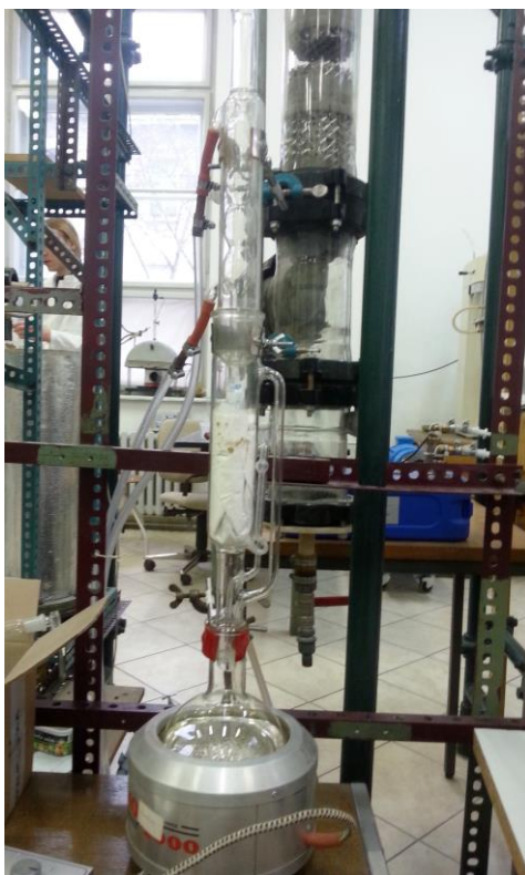
Slika 12. Aparatura za ekstrakciju po Soxhletu
