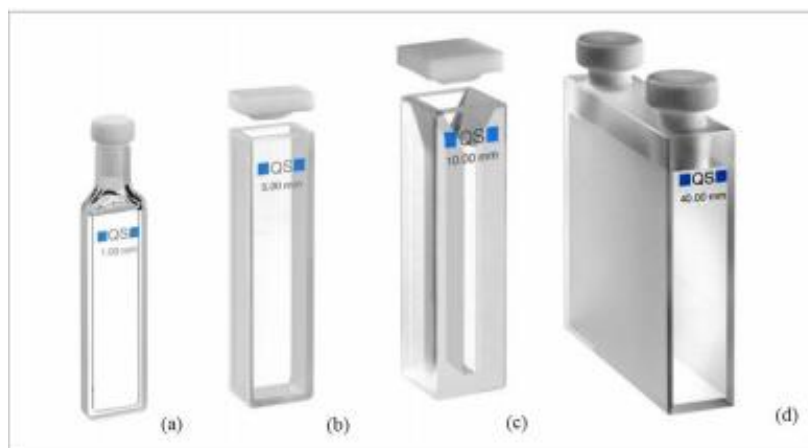
Slika 3. Kvarcne kivete namijenjene za snimanje UV/VIS spektara s ubrušenim i prozirnim stijenkama različitih debljina: (a) 1 mm, (b) 5mm, (c) 10 mm i (d) 40 mm
