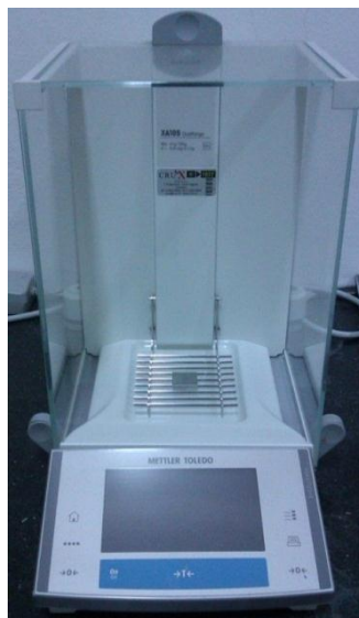
Slika 22. Analitička vaga Mettler Toledo XA105
