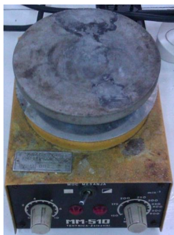
Slika 24. Magnetska mješalica Tehnica Železniki MM-510
