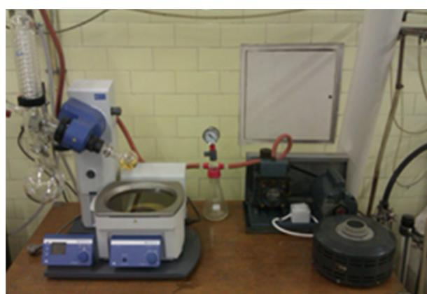
Slika 8. Rotacijski vakuum isparivač *IKA RV 10 basic* korišten za sintezu eutektičkih otapala.
