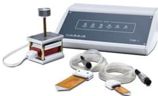
Slika 13. Uređaj za mjerjenje toplinske vodljivosti *Transient Hot Bridge (THB)*.
