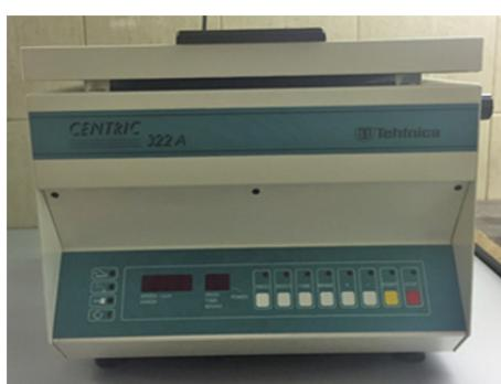
Slika 10. Centrifuga *Centric 322A (Tehnica)*.
