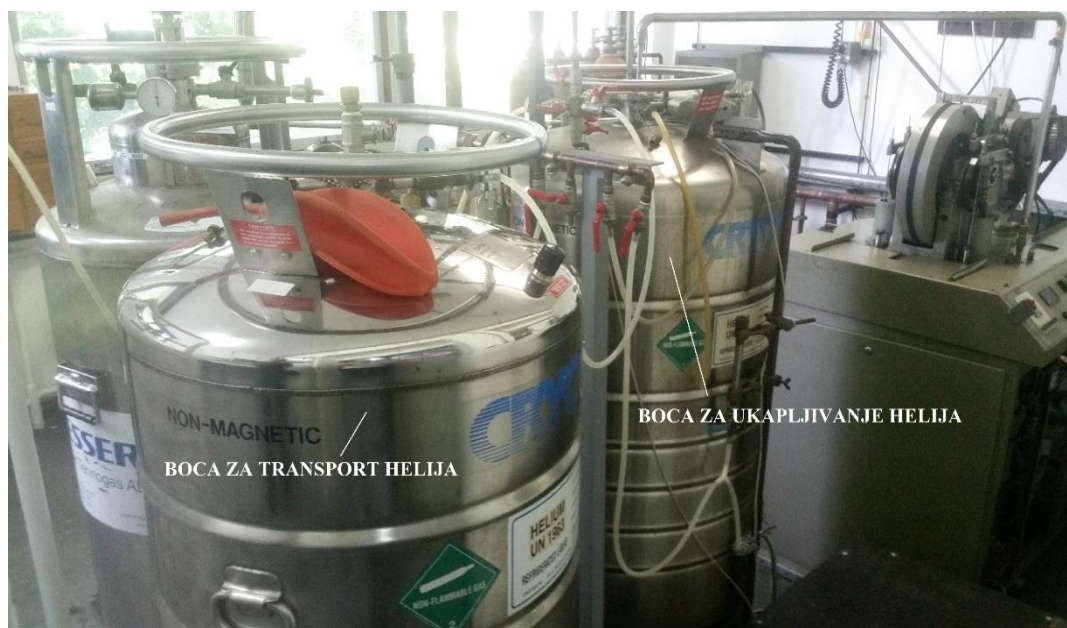
Slika 25. Boce za helij ( nehrđajući čelik + superizolacija )
