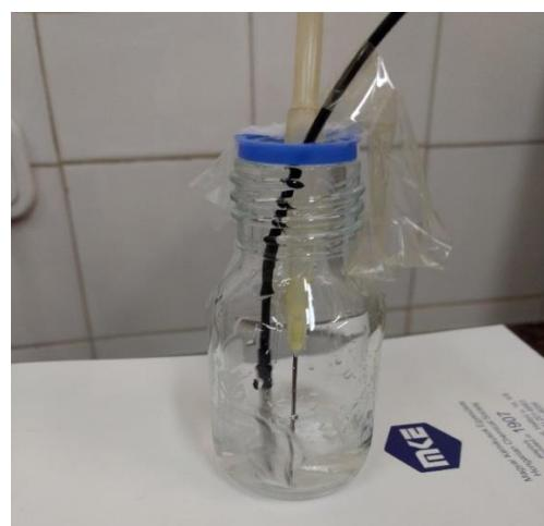
Slika 3.7. Schottova boca s kisikovom elektrodom i iglom za upuhivanje dušika
