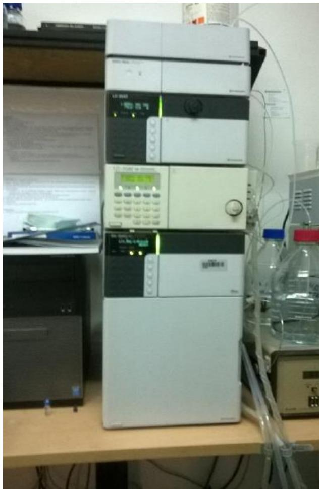
Slika 3.9. Uređaj za kromatografiju visoke djelotvornosti
