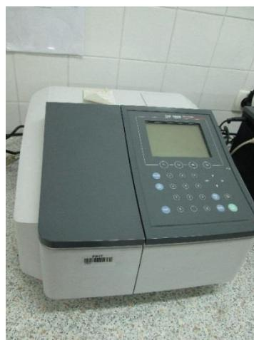
**Slika 4.** Spektrofotometar SHIMADZU UV-1800
