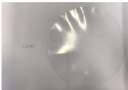
Slika 4.9. Film izrađen od čistog polietilena niske gustoće.
