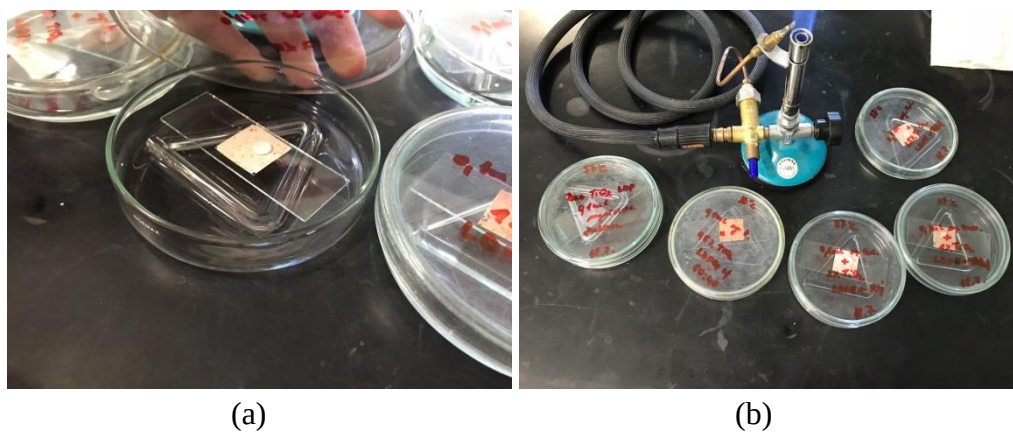
Slika 3.13. Postavljeni uzorak u Petrijevoj zdjelici (a) za različite udjele TiO 2 u filmovima LDPE/RLJ 60/40 (b).
