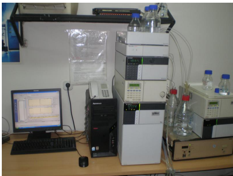
Slika 5. HPLC korišten za određivanje koncentracije fenola
