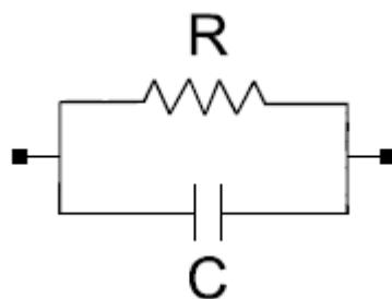
Slika 2.12. Ekvivalentni strujni krug za granicu faza elektroda/elektrolit
