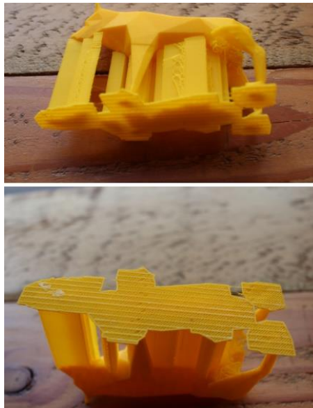
Slika 9. Prikaz 3D-tiskanog modela s opcijom raft
