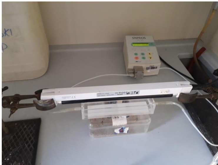
Slika 8: Korištena aparatura za ispitivanje fotokatalitičke aktivnosti.
