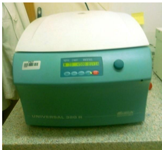
Slika 3.5. Centrifuga Hettich Universal 320R
