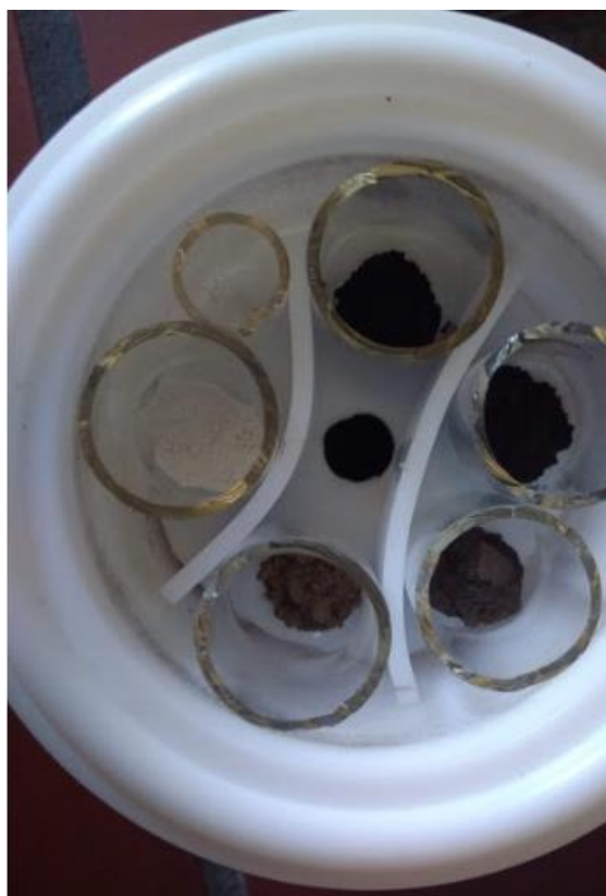
Slika 8. Uzorci prije (a) i nakon (b) sulfurizacije
