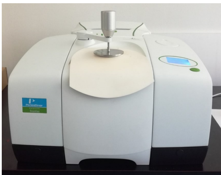
Slika 18. FTIR-ATR PerkinElmer instrument s dijamantnim kristalom.
