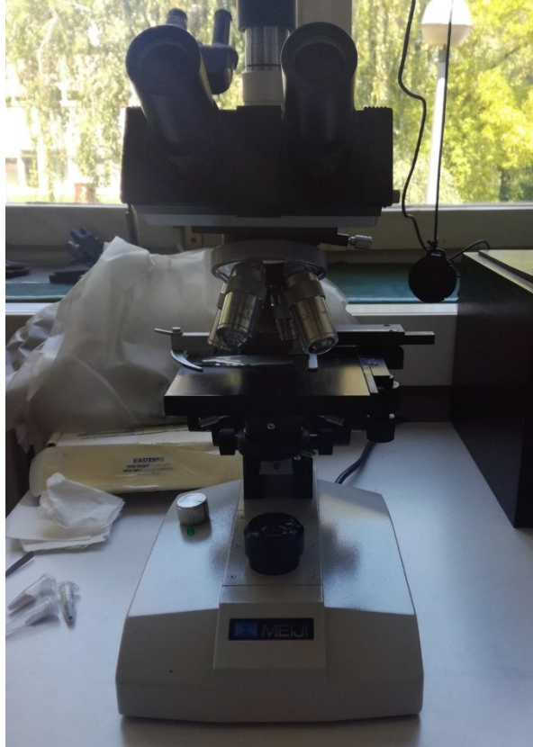
Slika 19. Optički mikroskop Meiji opremljen digitalnom kamerom Nikon Coolpix 990 pomoću kojeg su snimljeni promatrani uzorci uz povećanje slike 300x i 1000x.
