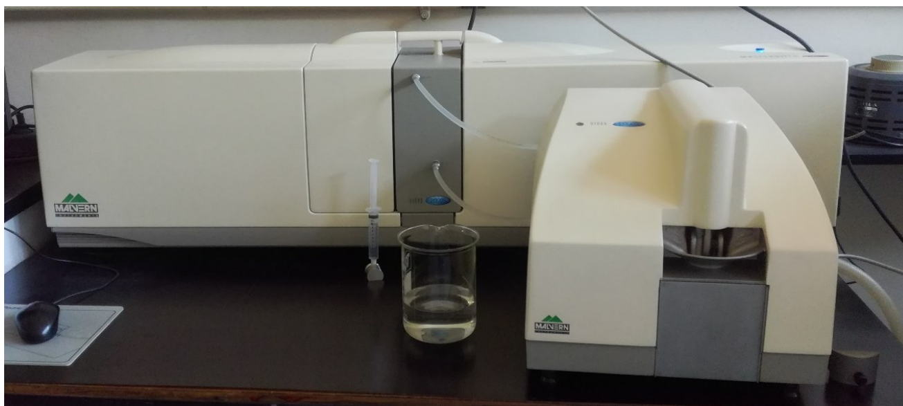
Slika 20. Malvern Mastersizer 2000 instrument za mjerenje veličine čestica.
