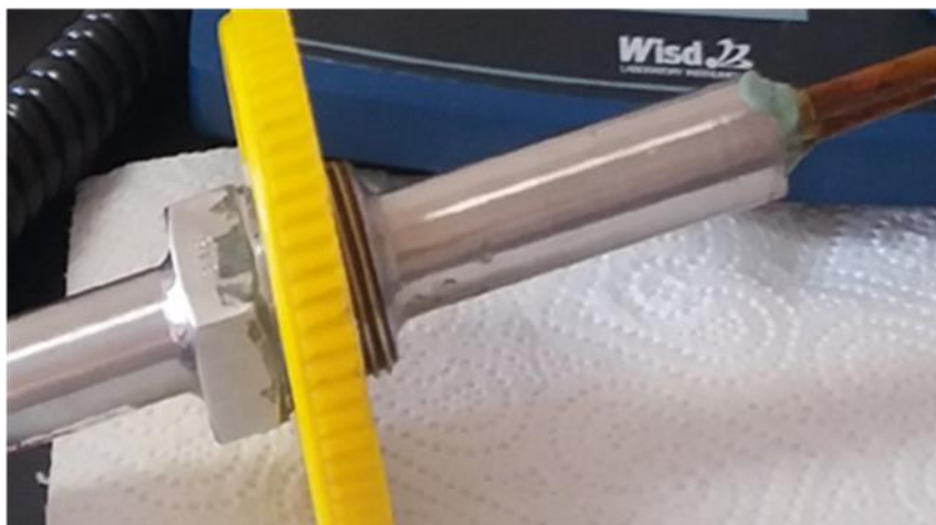
Slika 13. Formirani sloj hrđe na elektrodama LPR probe
