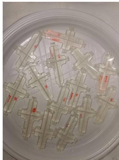
Slika 26. Reaktori a) prije stavljanja u komoru, b) nakon stajanja u komori 20 min
