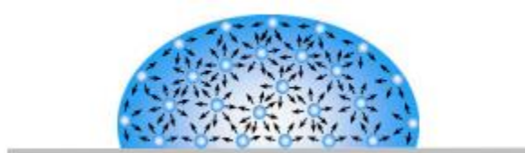
Slika 8. Ilustracija sila koje se javljaju unutar kapi tekućine [10]
